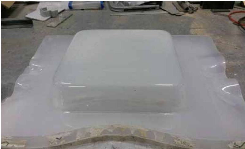
Design der Deckenleuchte für cartouche, abgebildet: Praxistests. Plexiglas, tiefgezogen. Kleinserie, 2017-18
